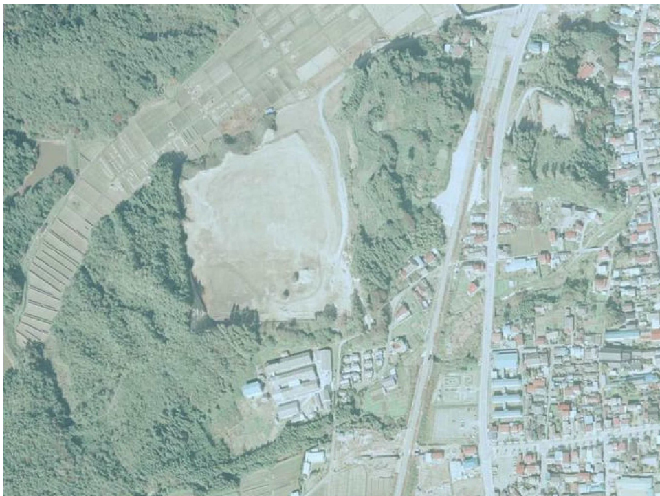
写真 3 : 双葉中学校グラウンド造成後の切土(丘陵地)と盛土(沢部)が確認される。1975 (S50)
