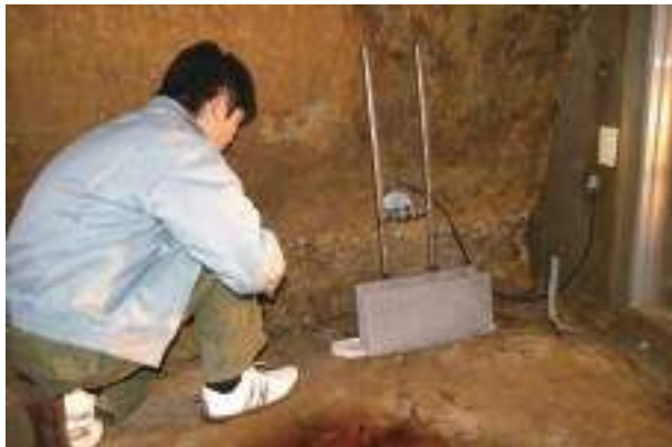
第3-45図 岩盤水分量測定機器設置
