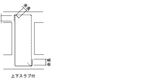
図2-3-6 副あばら筋、副帯筋の形状
