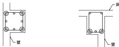
図2-2-1 フックが必要な重ね継手
