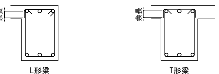
図2-3-4 あばら筋、帯筋の形状(溶接閉鎖形の場合)
